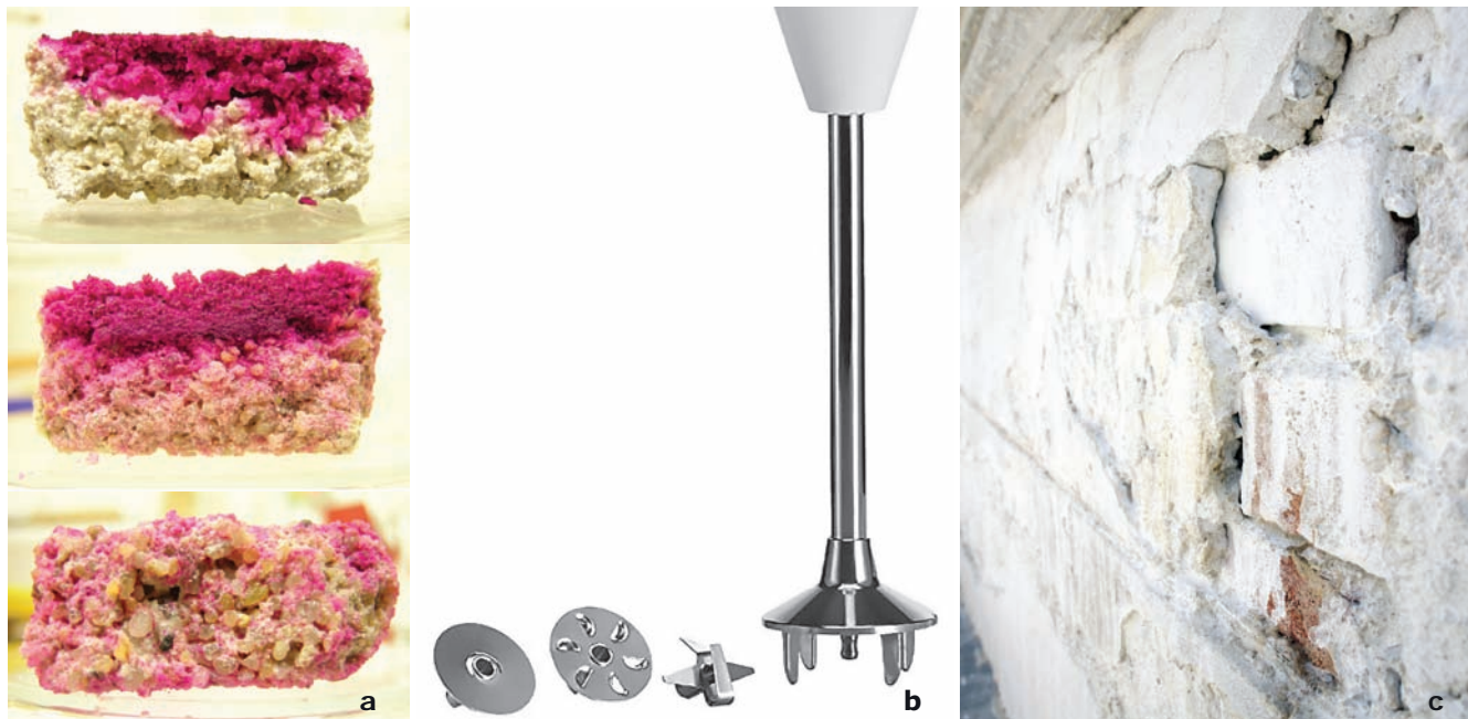
25. Konsolidacja wapnem hydratyzowanym: a. próbki tynku wapiennego lekko hydraulicznego. Próby konsolidacji: (po lewej) zachowanie szpachlówki wapiennej podczas penetracji wodą (niezdyspergowana), (w środku) zachowanie penetracyjne szpachlówki wapiennej w 1-propanolu (niezdyspergowana), (po prawej) zawiesina wapna hydratyzowanego zdyspergowana w 1-propanolu za pomocą miksera ręcznego. próba fenolftaleinowa. (HAWK, Vogler 2005); b. mikser ręczny z dyskami dyspersyjnymi; c. Wiedeń, elewacja z 1880 r., konsolidacja wapnem hydratyzowanym dyspergowanym na miejscu
