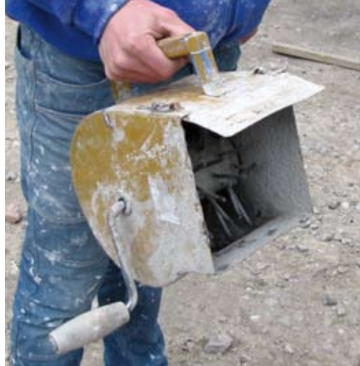
5. Urządzenie do narzucania tynku stosowane przy restauracji elewacji w Gdyni
