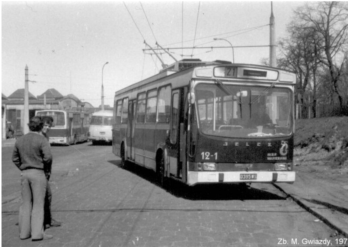
Fot. Pierwszy gdyński trolejbus Jelcz Berliet PR100, nr inw. 12-1 wyprodukowany przy wykorzystaniu używanego autobusu w warsztatach gdyńskiego oddziału WPK w Gdańsku (1977 r.) Ze zbiorów prywatnych Macieja Gwiazdy
