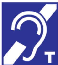
Ryc. 25. Symbol oznaczenia dostępu do informacji poprzez wykorzystanie pętli induktofonicznej do wzmacniania dźwięku w aparatach słuchowych (źródło: standardy ISO).
