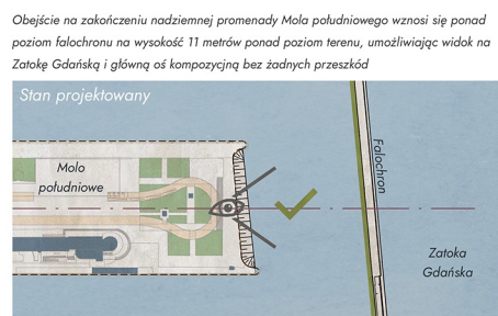
Przebieg na zakończeniu nadziemnej promenady Mola południowego wznosi się ponad poziom falachronu na wysokość 11 metrów ponad poziom terenu, umożliwiając widok na Zatokę Gdańską i główną oś kompozycyjną bez żadnych przeszkód
