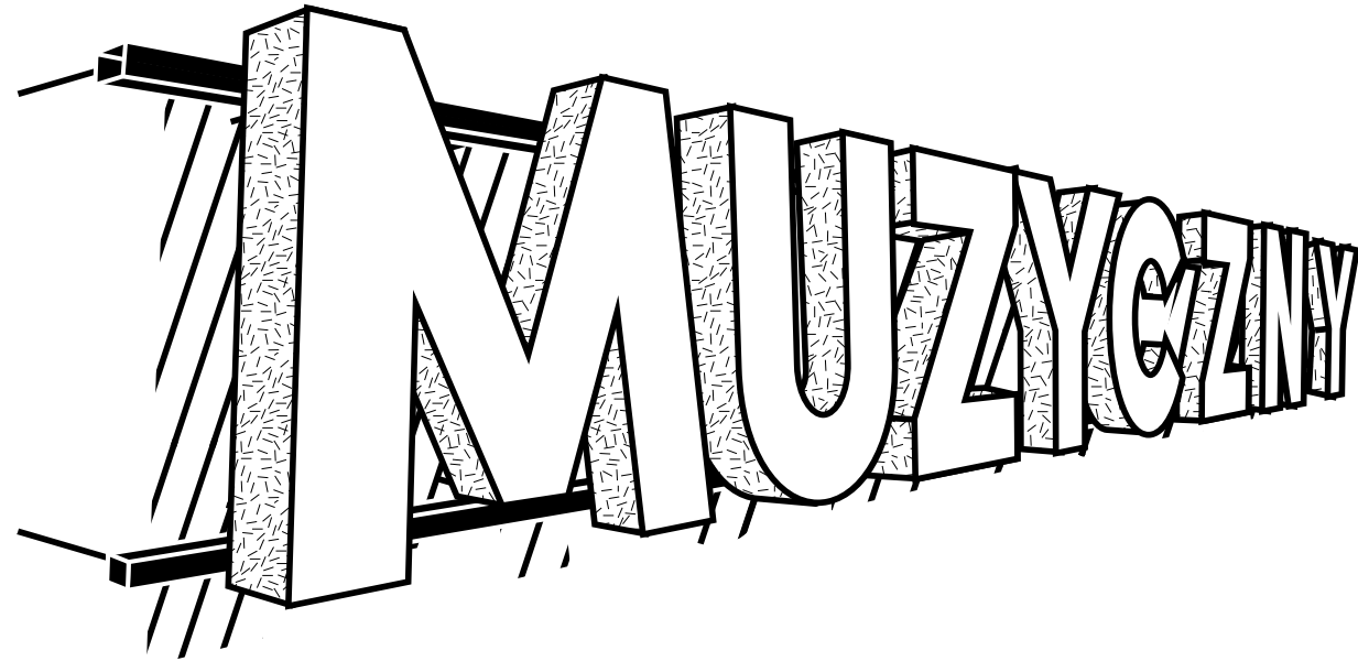
↑ Rys. 11. Szyld równoległy montowany na szynach.
